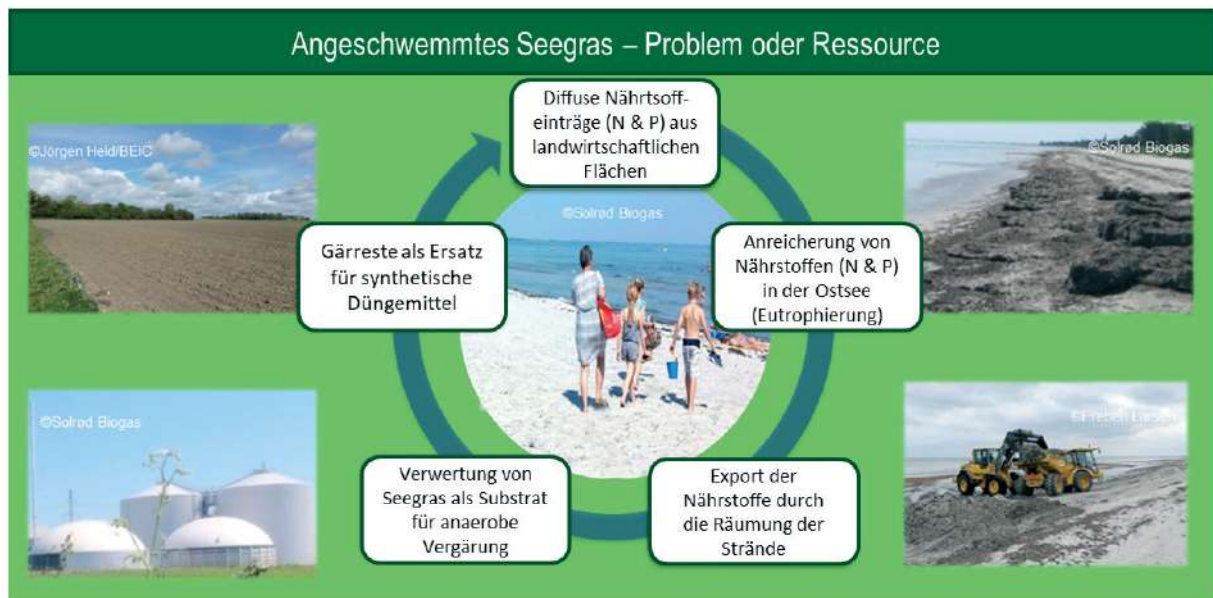
Abb. 1 Schema zur Rückführung überschüssiger Nährstoffe aus der Landwirtschaft durch die energetische Verwertung von Seegrass als Co-Substrat in der anaeroben Vergärung
